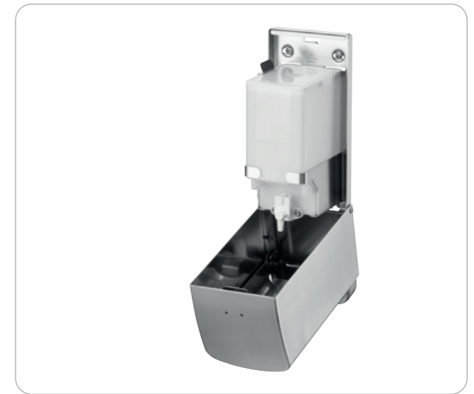
Gehäuse nach vorne geöffnet. Befüllung direkt im Spender möglich oder durch Herausnehmen des Nachfüllbehälters.
